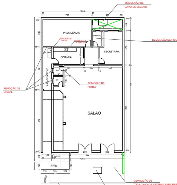
PLANTA BAIXA REMOÇÃO E DEMOLIÇÃO
