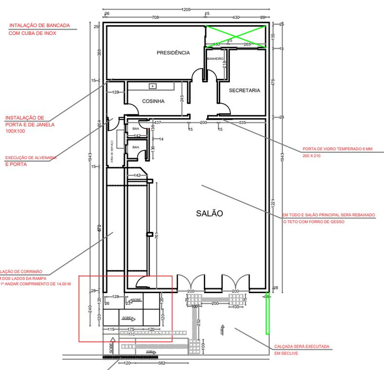
PLANTA BAIXA EXECUÇÃO E INSTALAÇÕES
