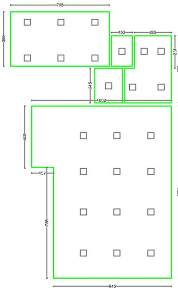
PLANTA BAIXA EXECUÇÃO DE TETO DE GESSO E ILUMINAÇÃO ÁREA= 159,80 M<sup>2</sup>
